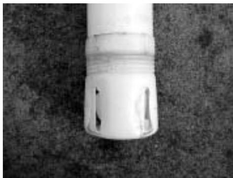
対策事例3 薬筒底部の調整（底部での高さ調整）
